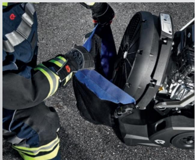
Schaumnetz über dem Lüfter montieren.
