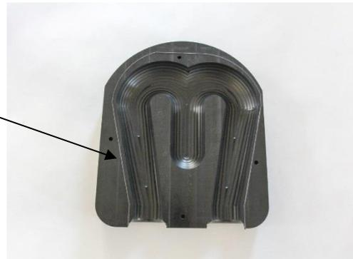
7. Setzen Sie nun den unteren Pumpenfuß auf den bereits montierten oberen Pumpenfuß und schrauben diese mit den vier M6 Zylinderschrauben zusammen. Zur Sicherung der Schrauben ist mittelfeste Schraubensicherung zu verwenden. Das richtige Schraubenanzugsdrehmoment entnehmen Sie bitte der Tabelle 6.3.1 Schraubenanzugsdrehmomente.
