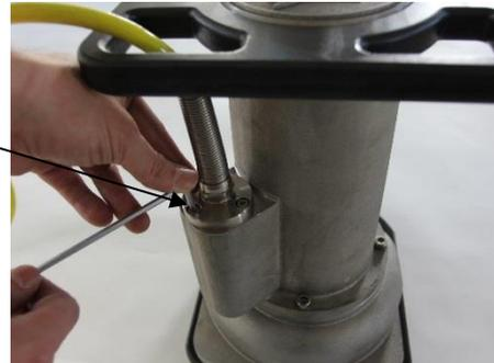
2. Ziehen Sie die Kabelverschraubung samt Stecker und Kupplung aus dem Gehäuse heraus. Öffnen Sie die Steckverbindung und ziehen den Stecker aus der Kupplung heraus.
