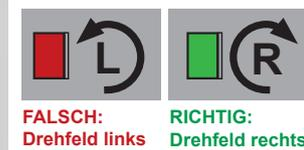
Bei Fehleranzeige lässt sich das Drehfeld ganz einfach umkehren – dank des im Stecker integrierten Phasenwenders
